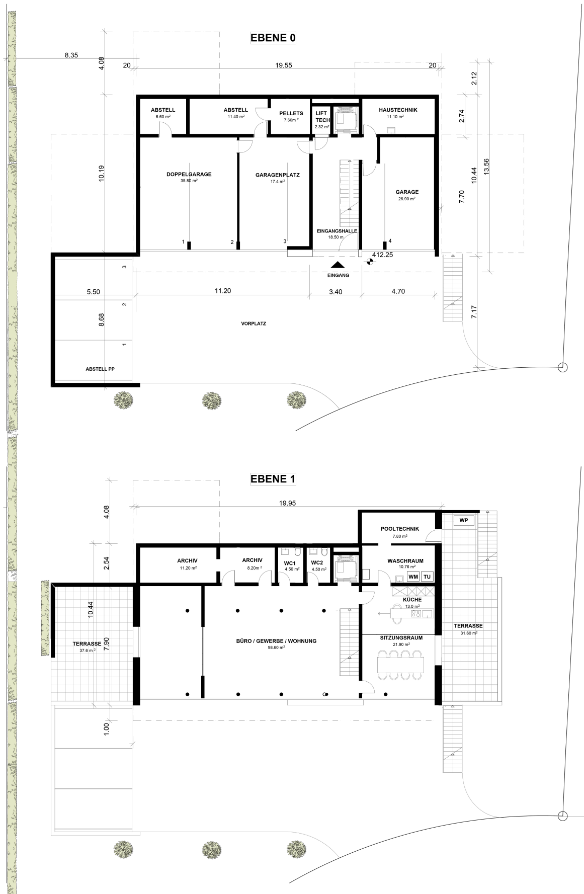
Grundrisse Ebene 0 (Garage/Entrée), Ebene 1 (Büro/Gewerbe)
